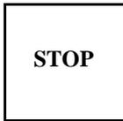
Fait terminer l'activité en cours (exécution ou programmation). Lorsque la machine est alimentée mais non pas en fonction, si on l'enforce en même temps que RESET, elle affiche la version du logiciel installé.
